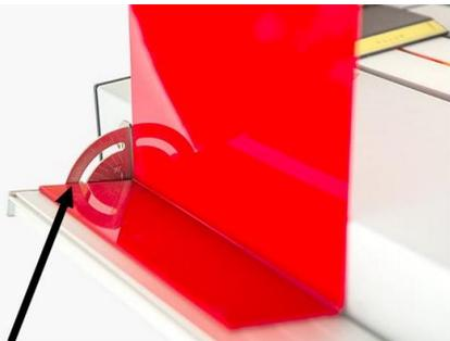
Une butée réglable permet de plier une série de pièces à même distance.
