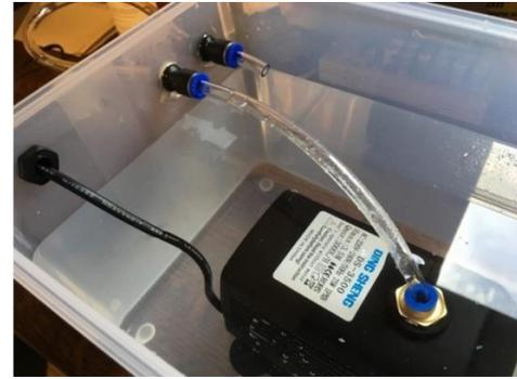
Les thermoplieuses Plythagore ont une zone froide assurée par une circulation d'eau autour de la résistance chauffante.
